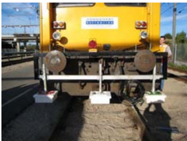
Figur 7. Georadargrej med 3 antenner fra Ground Controls undersøgelse i 2007
