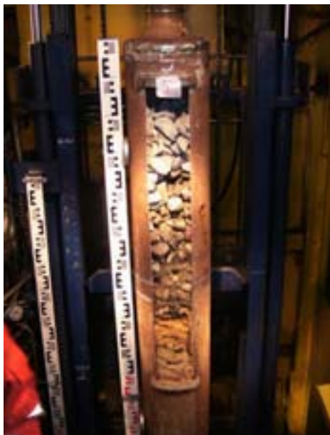
Figur 5. Sporkasseboring udført med rør med bred slidse.
