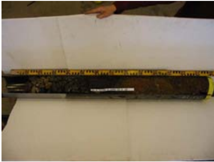
Figur 4. Gennemskåret plast-liner med prøve
